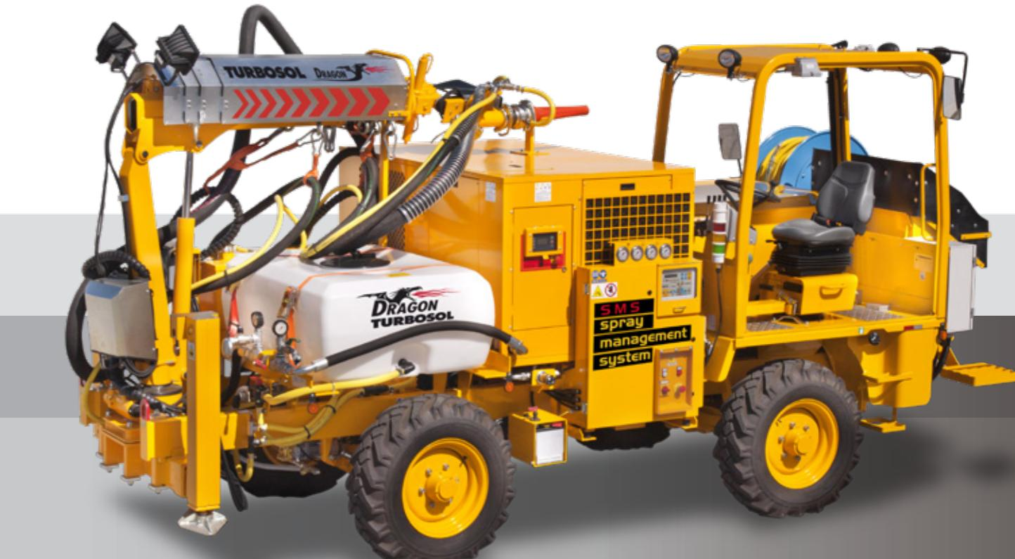
DRAGON: unité mobile, compacte et polyvalente aux hautes prestations, pour vos travaux de béton projeté.
